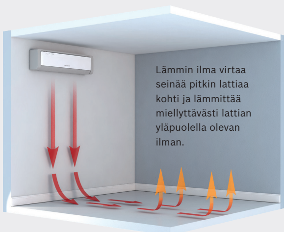
Lämpimän ilman ohjautuminen lämmityskäytössä vedon ehkäisemiseksi
